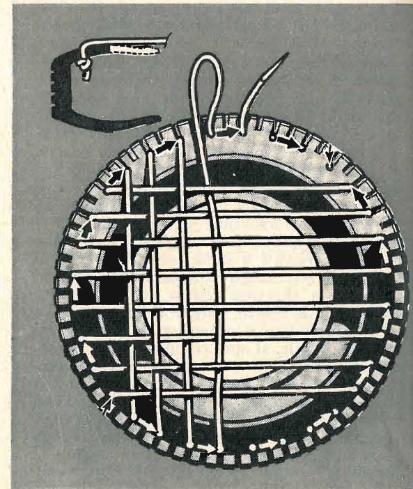
Fig. 2 - Ecco un originale impiego di un vecchio copertone d'auto. L'intelaiatura di corda di plastica, di cui la figura a sinistra mostra i dettagli costruttivi, trasforma il copertone in un tamburo elastico per saltare.
